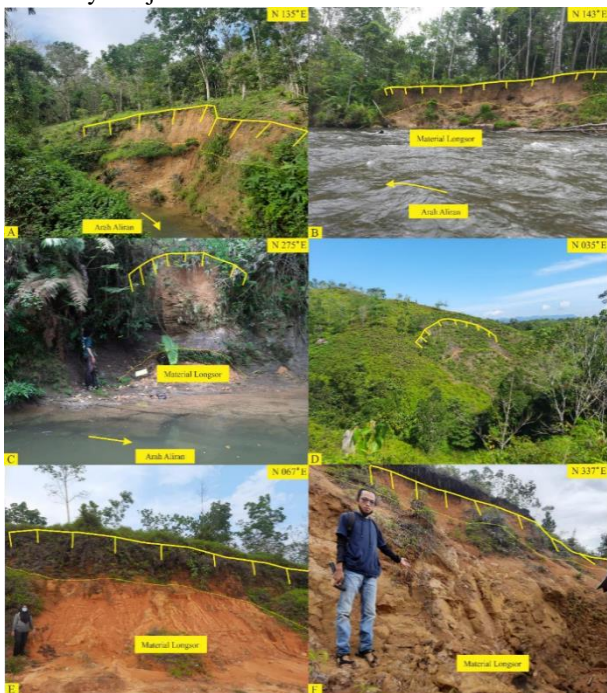
Gambar 4. Kenampakan longsor dilokasi Penelitian (A). Longsor Translasi di desa Muaro Paiti, (B). Longsor fall di sungai Batang Kapur gadang, (C). Longsor Rock fall di sungai Batang Paiti, (D). Longsor Translasi di desa Pulau Sialang, (E) Longsor Translasi di desa Durian Tinggi, (F). Longsor fall di desa Koto Bangun (Varnes, 1978).
