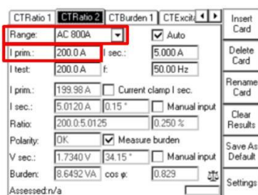
Gambar 2 Tampilan pada display OMICRON CPC 100
