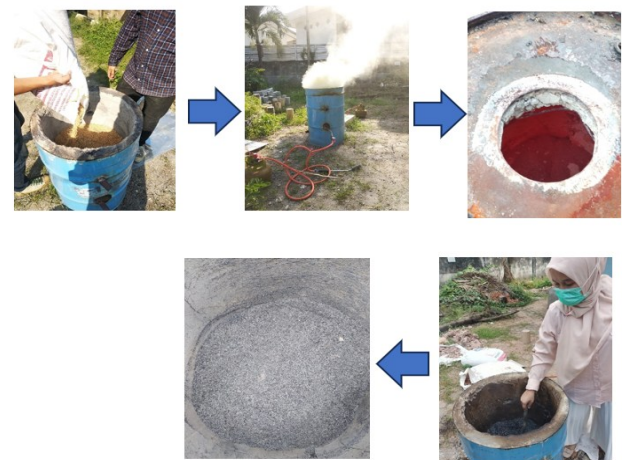
Gambar 1. Proses pembakaran limbah sekam padi dengan furnace buatan
