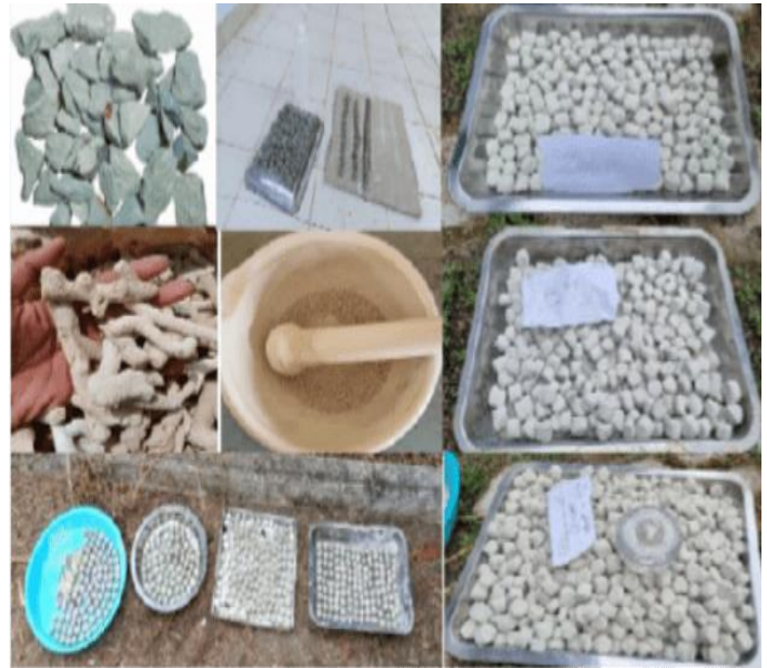
Gambar 2.(b). Pembentukan Adsorben Zeolit; Batu Karang Jahe dan Kombinasi keduanya menjadi Pellet
