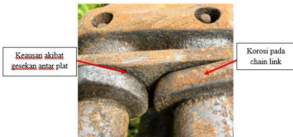
Gambar 3. Kausan dan Korosi pada Link Chain
